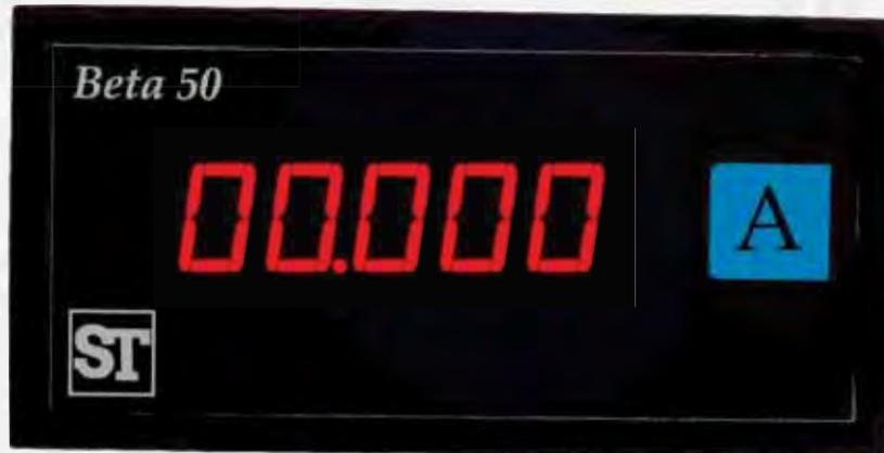
**Beta 50/60/70** Es un medidor de panel digital utilizado para la medición de parámetros eléctricos como voltios, mili-volts y corriente. Se utiliza principalmente en laboratorios.
